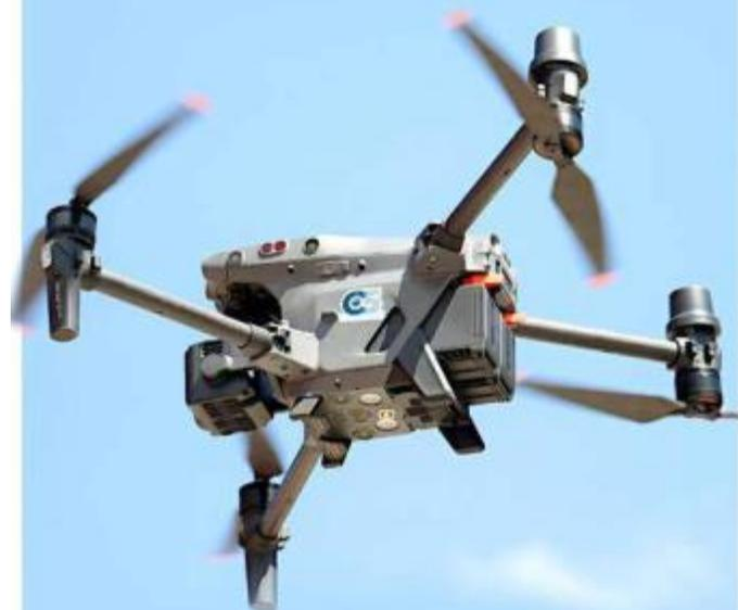
■ Los drones tienen cámaras de 360 grados con visión nocturna que permite identificar las zonas de calor.
